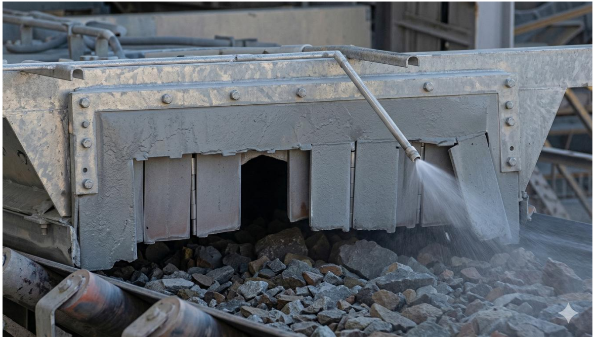
Figure 8. Sello transversal tipo existente
