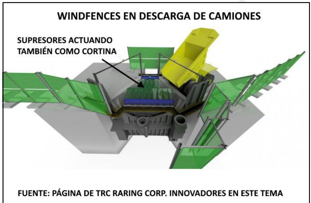
Figura 13. Esquema con ubicación de windfences de TRC Raring
